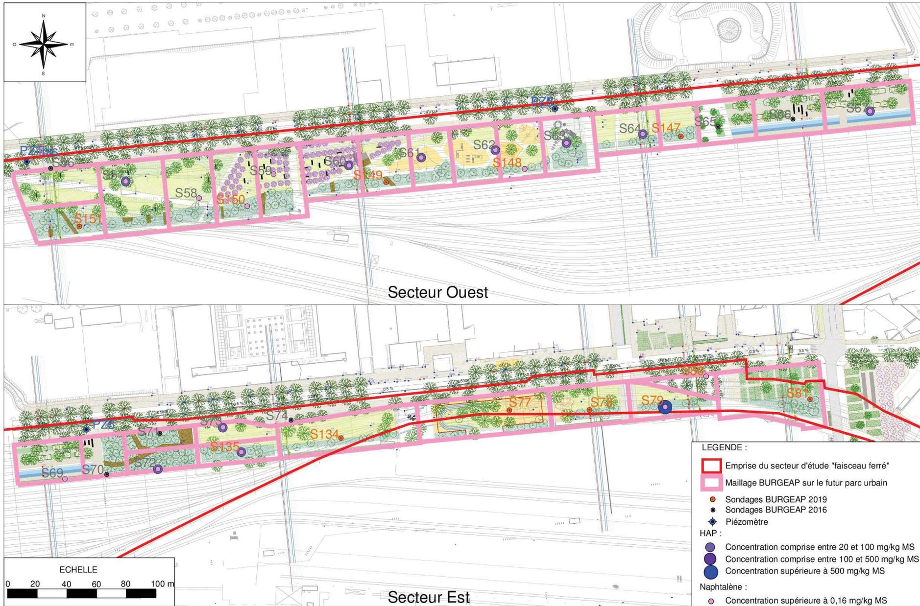
Figure 9 : Localisation des anomalies et impacts en HAP et naphtalène dans les sols
