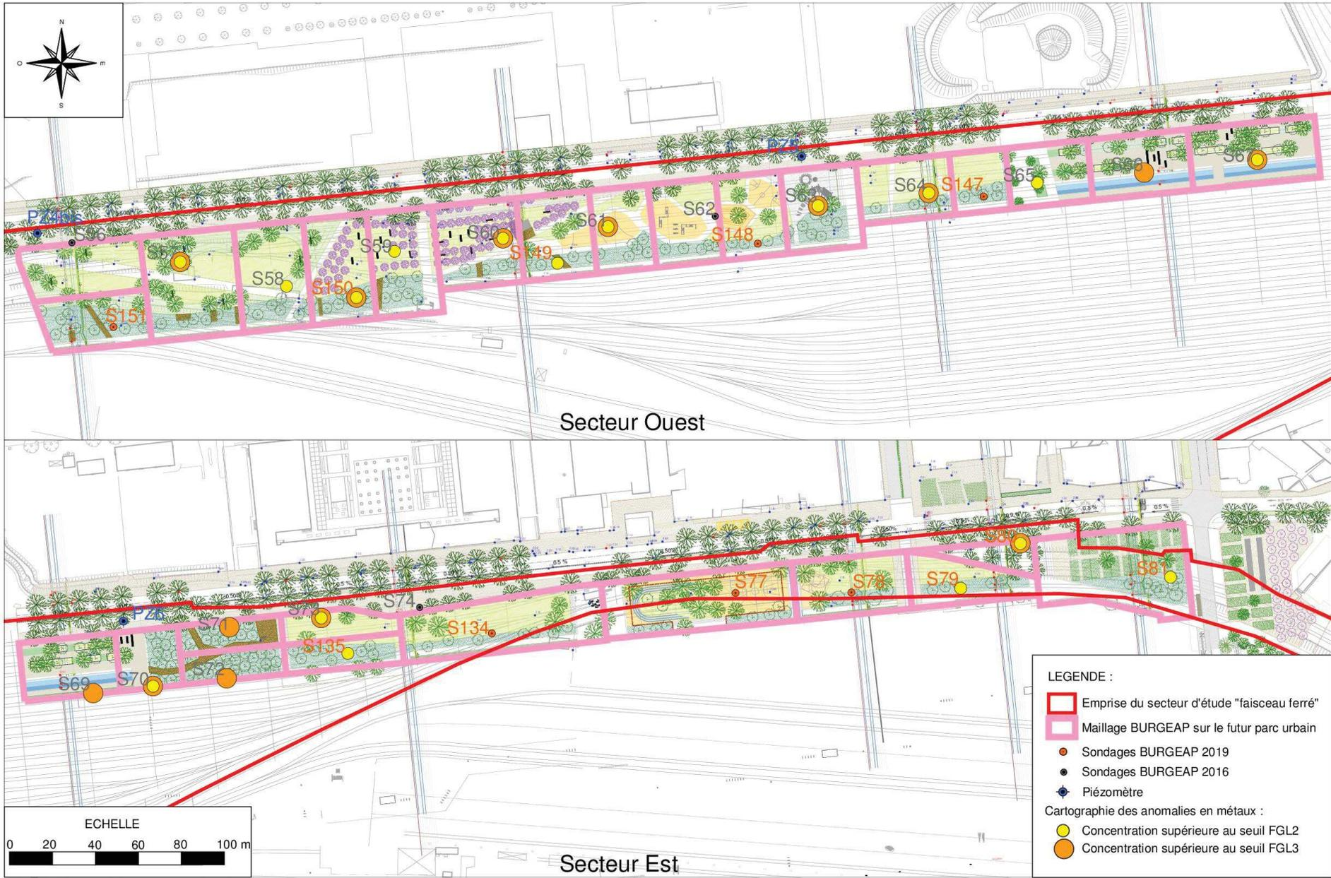
Figure 7 : Répartition des anomalies en métaux dans les sols (hors molybdène et sélénium)
