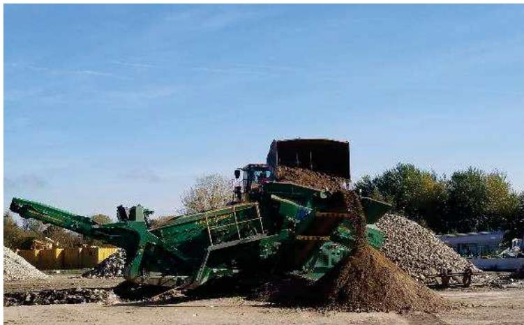
CRIBLAGE DE MATERIAUX PAR UN CRIBLE ET UNE CHARGEUSE
