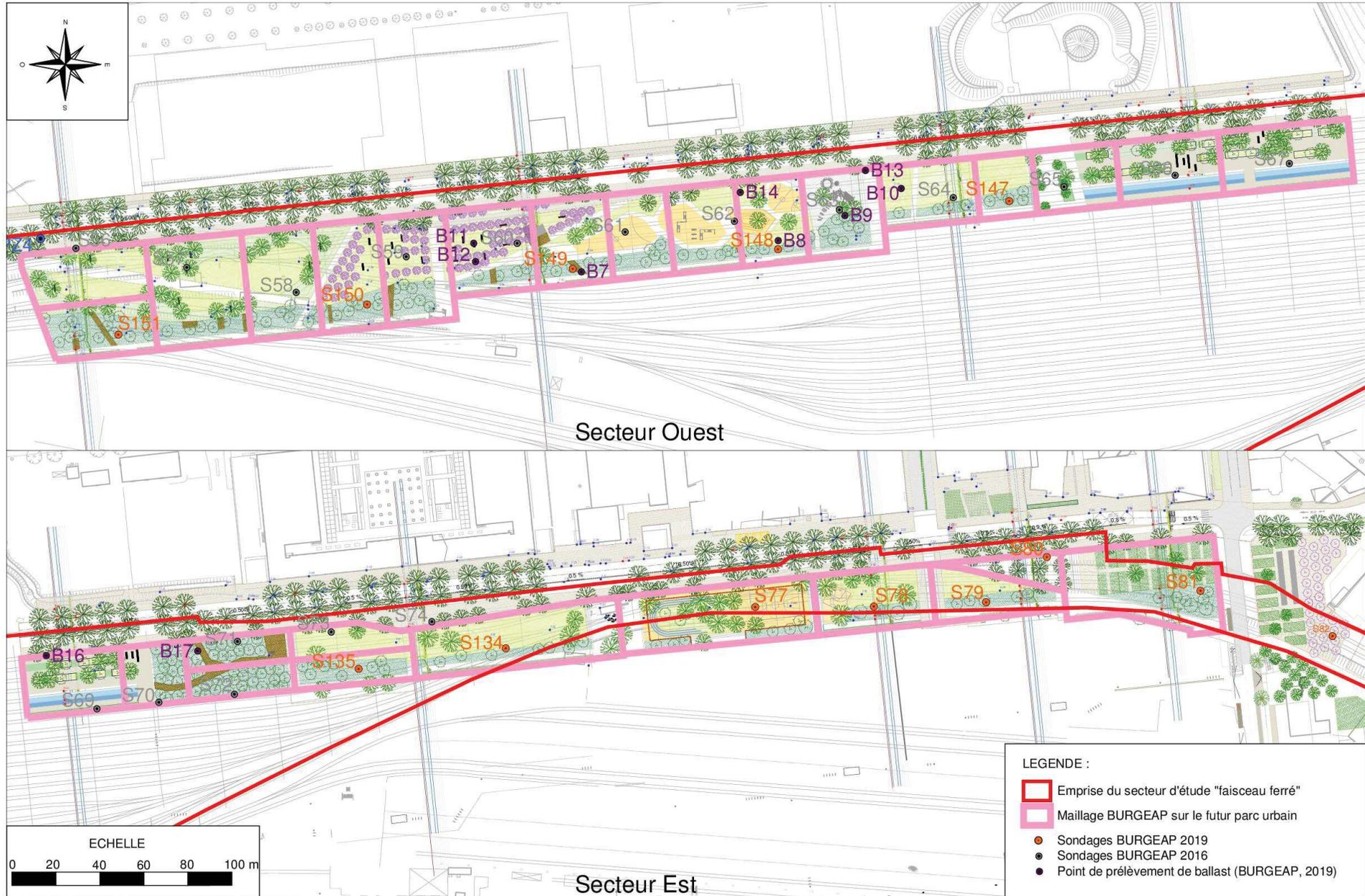
Figure 13 : Localisation des investigations réalisées sur les ballasts
