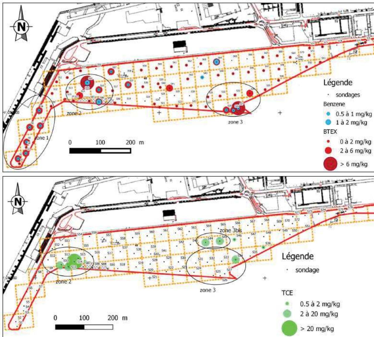
Figure 4 : Résultats des investigations de 2016 pour les BTEX et le trichloroéthylène
