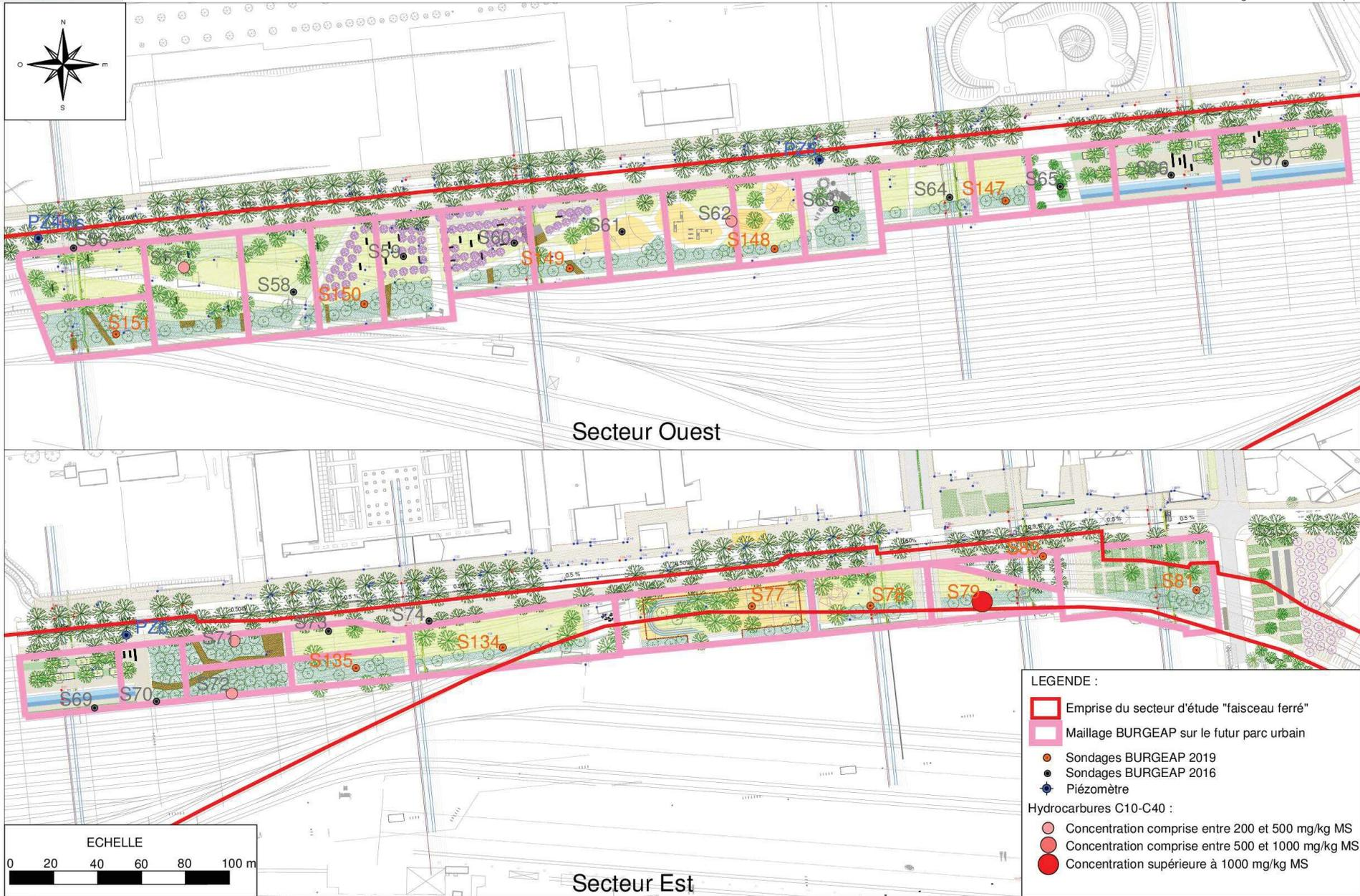
Figure 10 : Localisation des anomalies et impacts en hydrocarbures dans les sols
