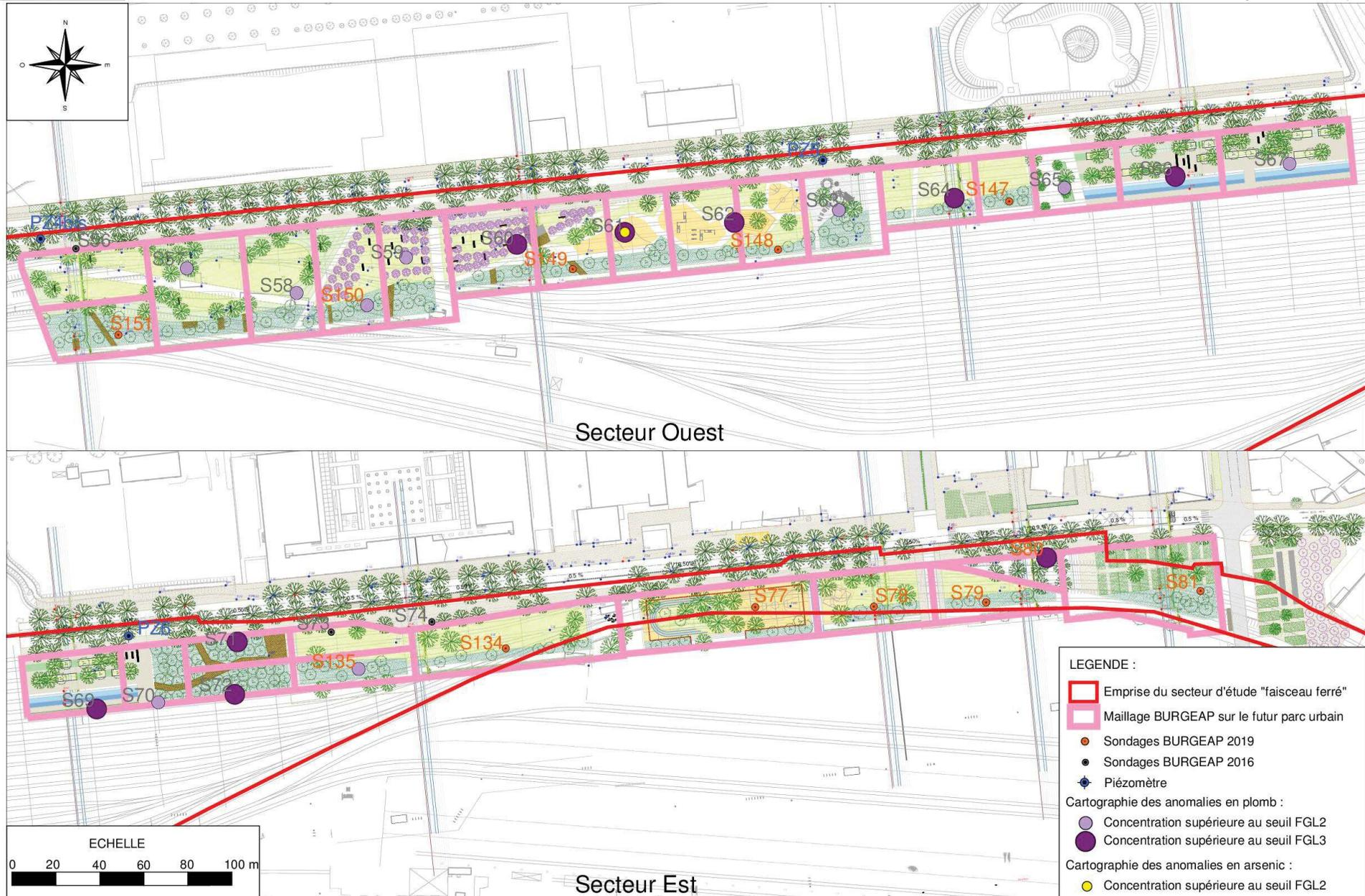
Figure 8 : Répartition des anomalies en plomb et arsenic dans les sols
